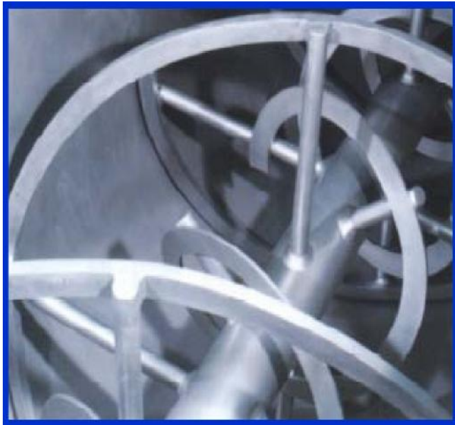
MUESTRA DEL EXCLUSIVO AGITADOR DE CINTA EN DOBLE HÉLICE DE LA MEZCLADORA DE CINTA MORTON
